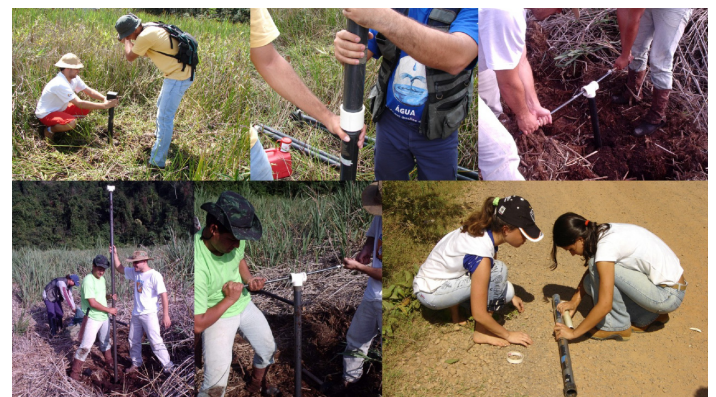
Figura 3: Seqüência desde o processo de percussão manual, passando pela adição de eletrodutos, retirada e finalizando com a preparação do material para transporte.
